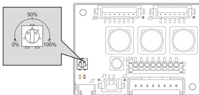
Figura 3-20 Potenziometro P1 – Posizione di montaggio e campo di regolazione
