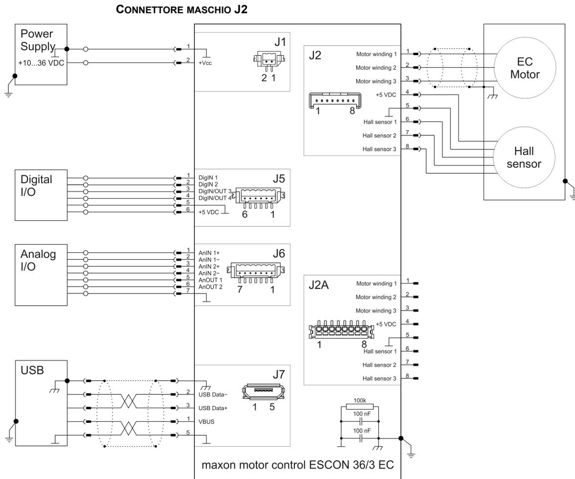
Figura 4-23 maxon EC motor con sensori Hall (J2)
